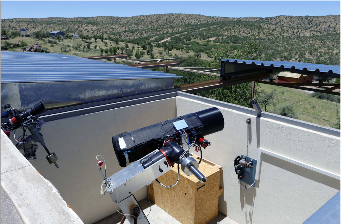
Abb. 2: Das „Wolfoskop“: 10“-Newton mit Equipment
